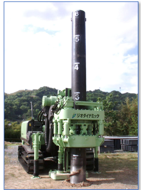
CHR 工法（つばさ杭施工機）
